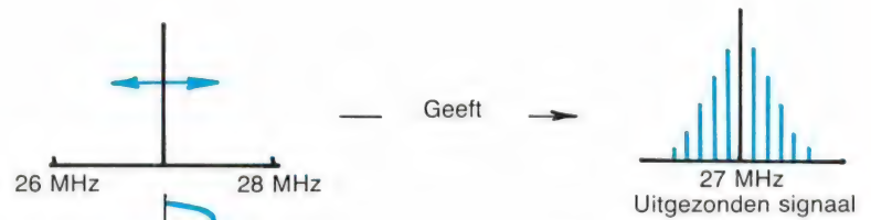
Fig. 4 FM modulatie is het verschuiven van de uitzendfrequentie
